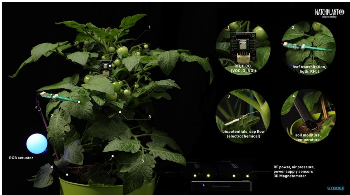
Planta de tomate monitorizada con los sensores desarrollados en WatchPlant
